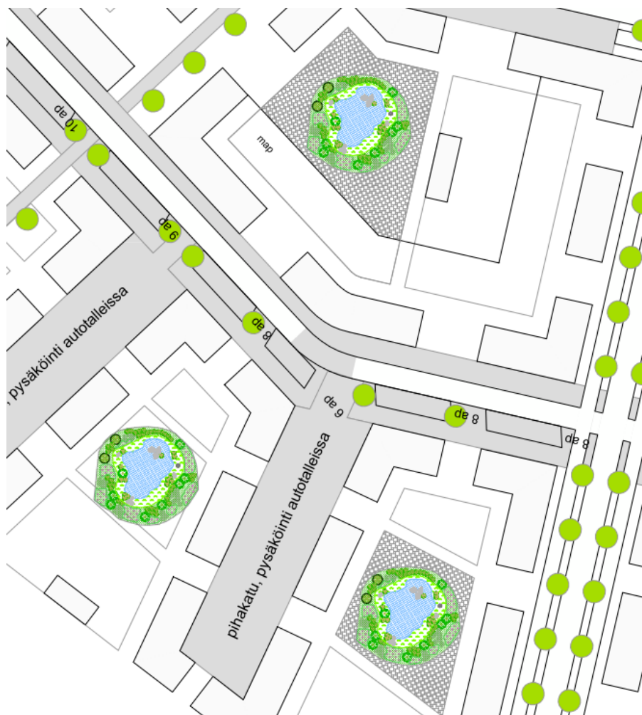
Kuva 12. Sadepuutarhan tyyppikuva paikalliseen hulevesien hallintaan.
